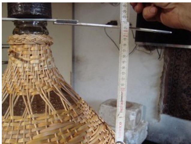
Obr. 38: Na tento demizón dávam uchá do výpletu, ktorý je od hrdla 23 cm. Preto dokončím riadok a vkladám rýmovku pre uchytenie úch.
