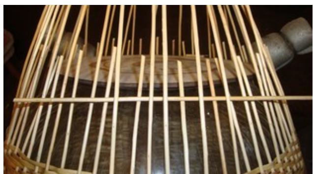
Obr. 65: Dno, ktoré má 280 mm stačí zachytiť polovičným počtom osnov, preto každý druhý prút skrátim tak, aby prečnieval nad dnom asi 2 cm. Tým som zamedzil vzájomnému odtláčaniu prútov a lepšie sa mi bude výplet pritláčať na sklo. Pretože počet osnov je nepárny, musia zostať dva neskrátené prúty vedľa seba. Sú v strede obrázku podložené prútom.
