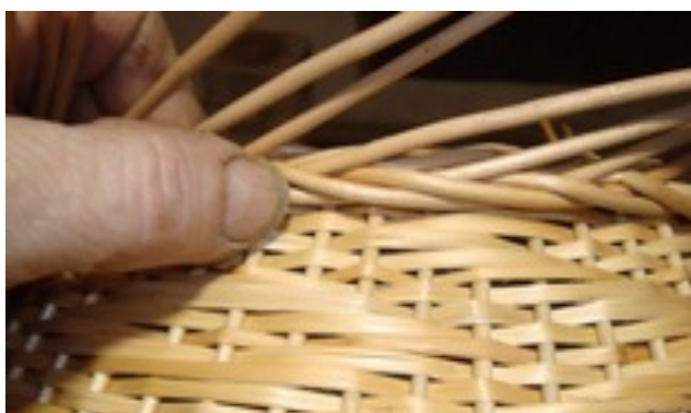
Obr. 79: Dokola túto lemovku ešte zatláčam palcom. Potom sú všetky oblúčiky rovnako doľahnuté.
