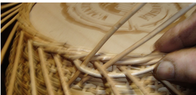
Obr. 77: Tvorba bočnej lemovky, ktorá chráni výplet pri dne. Pod dva prúty podložím kôličky a prúty zakladám ťahom „pod 2 nad 1“.
