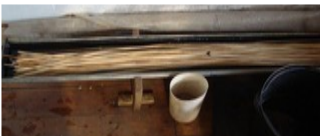
Obr.3 Z dolných dvoch tretín prúta sú nastrihané prúty, ktoré sa po varení zbavia kôry. Rozštípu sa a viacnásobným hobľovaním sa zbavia dužiny na hrúbku 0,6 -1,0 mm.
