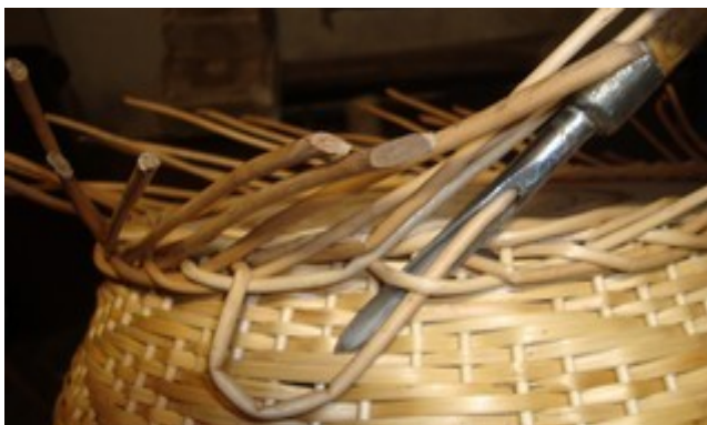
Obr. 78: Količky vytvorili medzeru na vsunutie posledných prútov, ktoré na konci zarežem do špičky. Použitím žliabku to ide lepšie.
