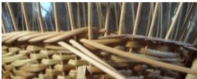
Obr. 48: Ďalšie končiace prúty prekryjú nadloženie. Treba ich tlačiť na sklo, aby pridržali predchádzajúci prút.
