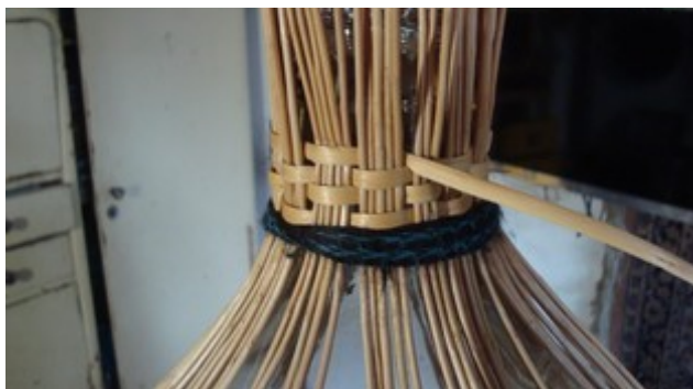
Obr.5: Lubky, ktoré sa opletajú cez, musia sa pred opletením palcom stačiť tak, aby sa dotýkali skla, musia sa prehnúť.
